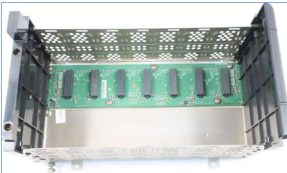
Figura 1 – Módulo de rack de chassi de 7 slots Rockwell Automation 1756 ControlLogix.
